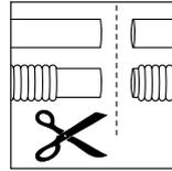
Beim Abschneiden eines gerippten Schlauches muss vom glatten Abschnitt so viel wie möglich erhalten werden. Dadurch wird beim Anschluss des Konnektors eine sichere Verbindung zwischen ihm und dem Schlauch sichergestellt.
